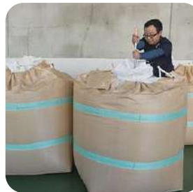
⑫ 二重管穀刺しで検査用の米を採取
